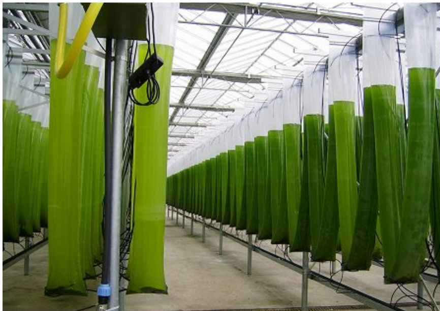
Abb.3: PBR, geschlossenes Foliensystem
